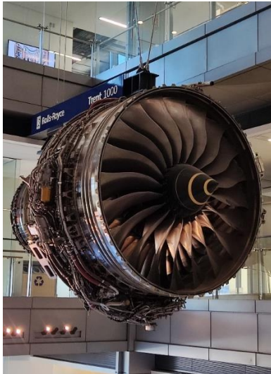
Abbildung 16: Rolls Royce Trent 1000, ausgestellt in der Goodwin Hall
