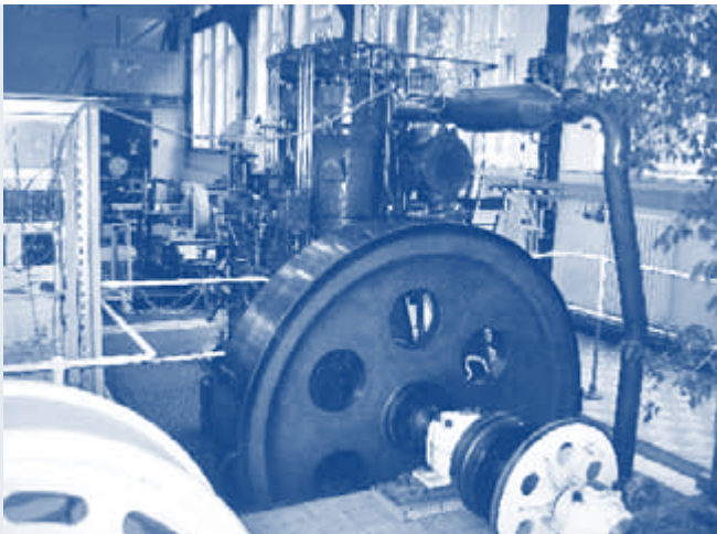
Schwungrad in der alten Maschinenhalle
