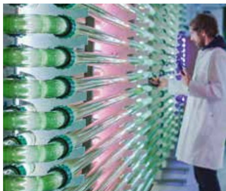
In vielen Kilometern Glasröhren züchtet Sea & Sun Technology Mikroalgen.
